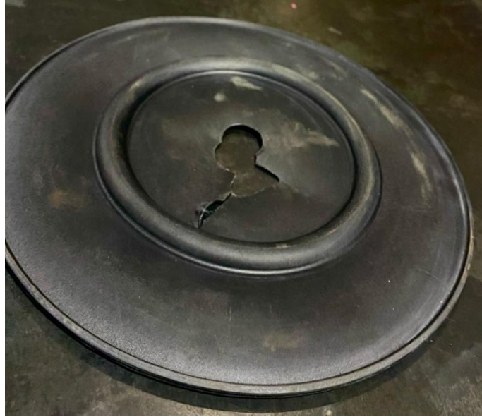
Şekil 7. Test Sonrası Orta Yüzeyden Patlayan Diyafram
