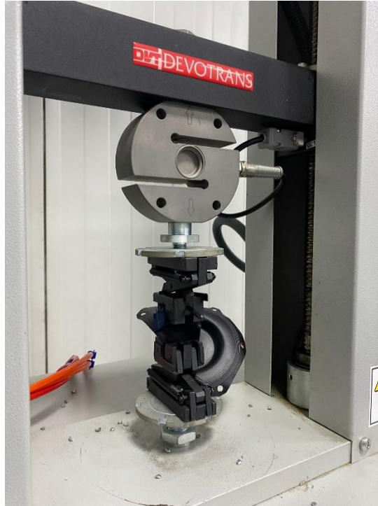
Şekil 2. Kort Bezli Diyaframların Çekme Kopma Mukavemet Testleri
