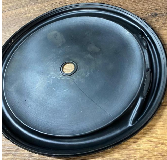
Şekil 6. Test Sonrası Kenar Bantlarından Açılan Diyafram
