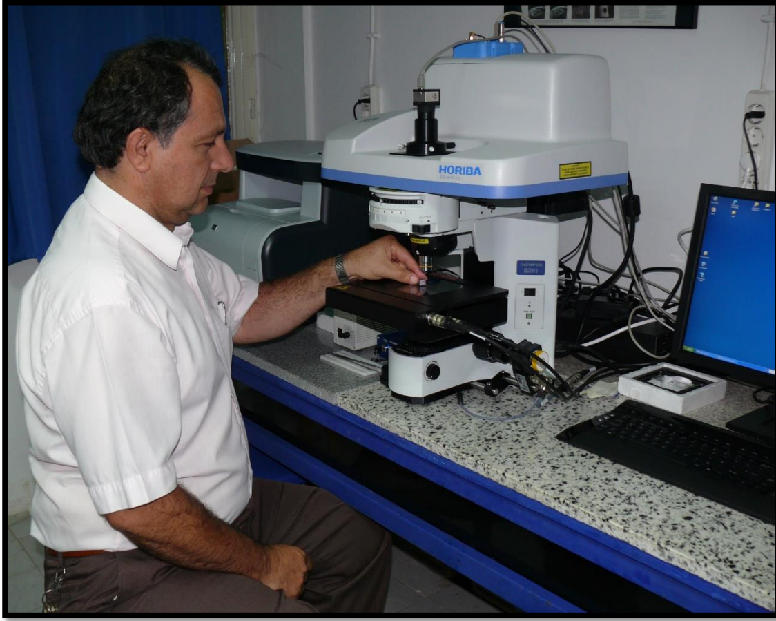
Şekil 4. Saçınımsal konfokal mikro-Raman spektrometresi. Raman spektroskopisinde, bir örnek çok kuvvetli bir monokromatik ışık kaynağı (532 nm lazer) ışınlanır ve böylece incelenen örnek yapısının moleküler titreşimi sağlanır.
