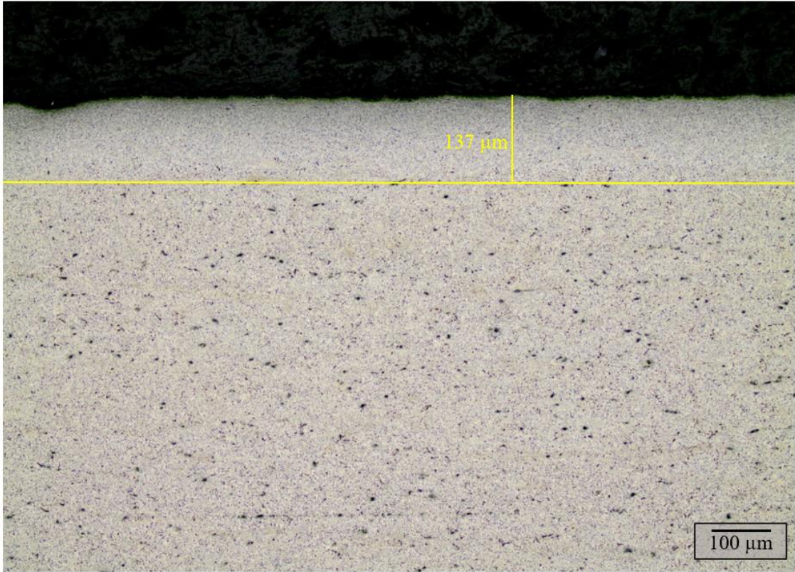
Şekil 4. 5 saniye işlem süresi ve 90 mm işlem mesafesi ile bilyalı su jeti dövme uygulanmış numunenin kesit optik mikroskop görüntüsü
