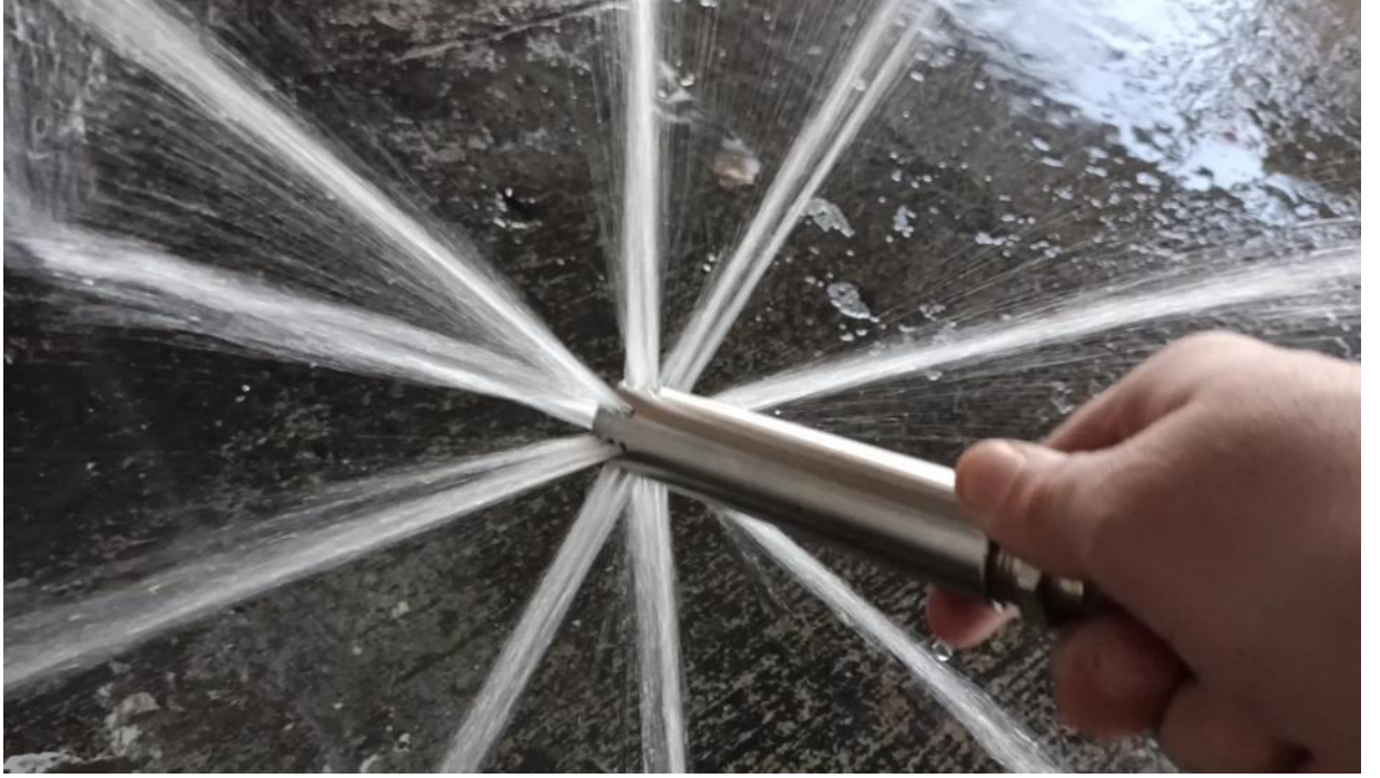
Şekil 6. Gıda Tankeri Temizleme Hattı Kullanılan Nozul
