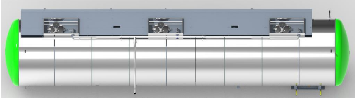
Şekil 3. Gıda Tankeri Temizleme Hattı Montajlı Tasarım Render
