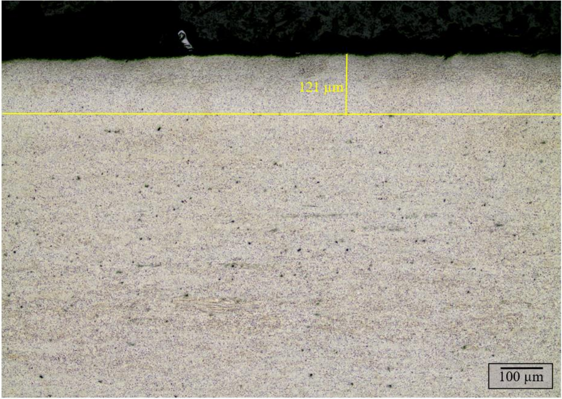
Şekil 3. 3 saniye işlem süresi ve 90 mm işlem mesafesi ile bilyalı su jeti dövme uygulanmış numunenin kesit optik mikroskop görüntüsü
