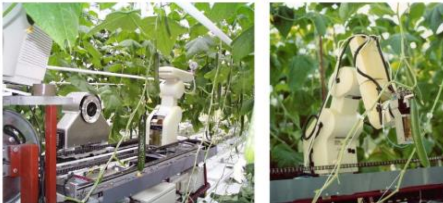
Şekil 2. Hıyar hasatı için geliştirilen insanı robot (Henten ve ark., 2003)
