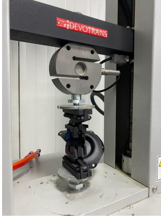
Şekil 2. Kort Bezli Diyaframların Çekme Kopma Mukavemet Testleri
