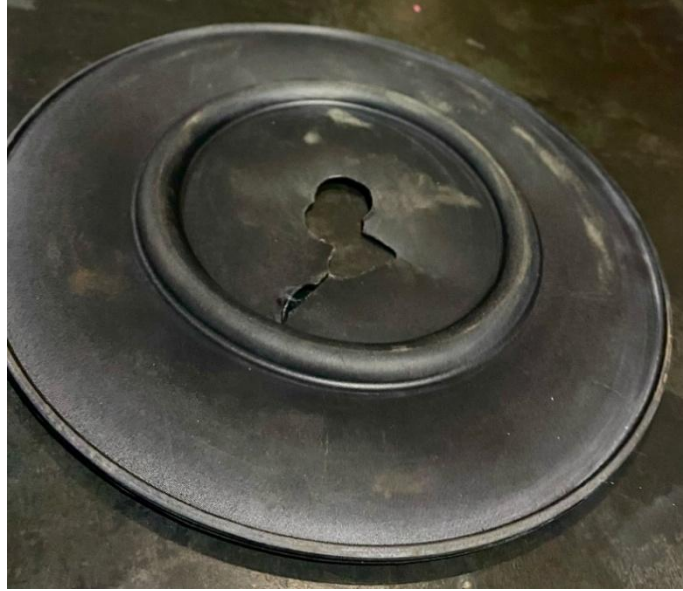
Şekil 7. Test Sonrası Orta Yüzeyden Patlayan Diyafram
