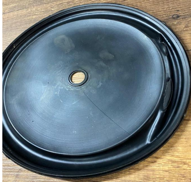
Şekil 6. Test Sonrası Kenar Bantlarından Açılan Diyafram
